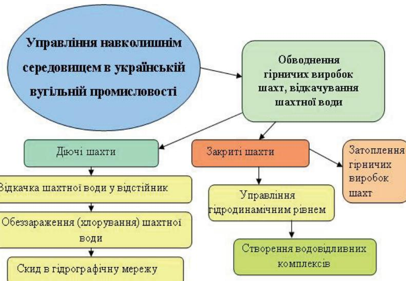
Рис. 4. Елемент діаграми зв'язку, який відображає поводження з шахтною водою
