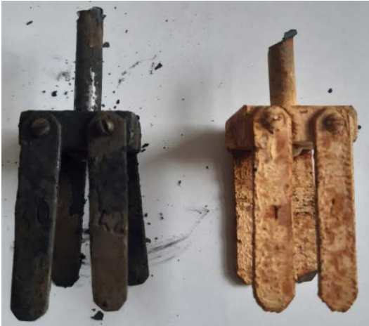
Рисунок 1. Зовнішній вигляд зразків після витримки у підземній воді свердловин
