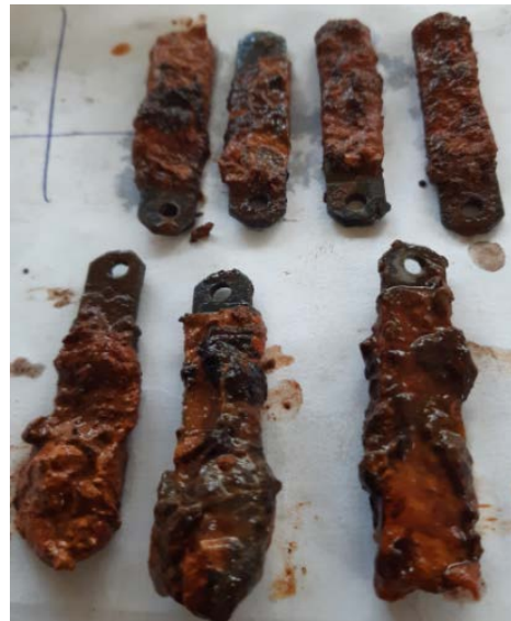
Рисунок 3. Зовнішній вигляд зразків після витримки в напірному трубопроводі NS-2.
