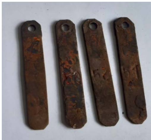
Рисунок 4. Загальний вигляд зразків після витримки в напірному трубопроводі НС -1.
